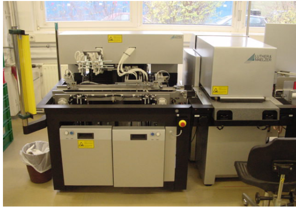
Netzlistenprüfung mit Prüfadapter (Mehrkosten)
