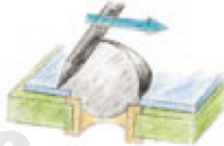
2 Pastendruck: Lotpaste in THR- Bestückungslöcher füllen
