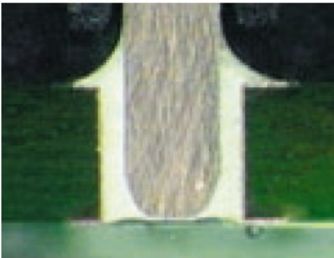
Schnitt durch THR-Lötstelle mit kurzem Stift
